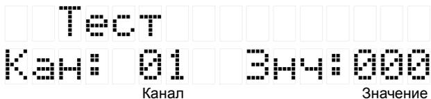
Кнопки <◀> и <▶> устанавливают канал, а <▲> и <▼> изменяют значение для него. Ключевое слово ìВсеî позволяет производить управление всеми каналами одновременно. Нажатие кнопок <Enter> или <Menu> позволяет выйти из режима.
